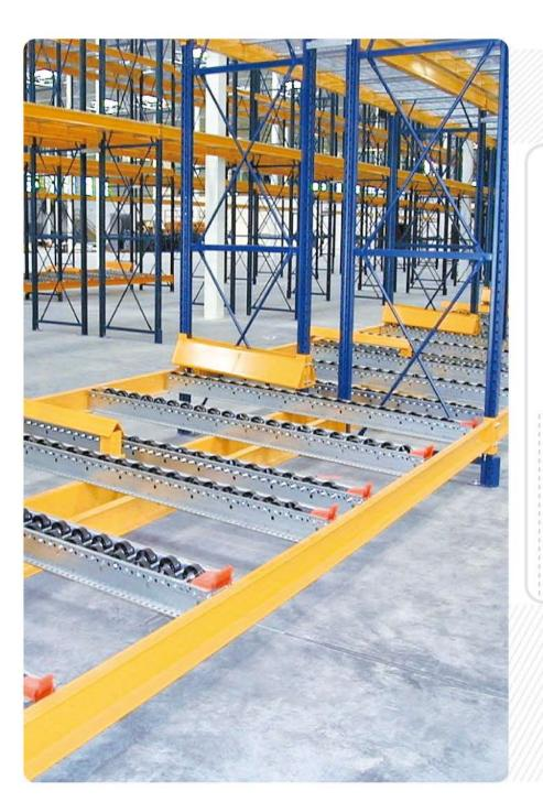
滚筒式货架也叫重力滚筒线,它的原理与压入式货架相同,滚筒按一定角度倾斜固定在货架横梁上,托盘从高端放入,沿滚筒线靠本身重力下滑,为控制托盘以稳定速度下滑,数控制托盘以稳定速度下滑速度,在滚筒线上每隔一定下滑速度越快,阻尼系统产生的阻力越大。滚筒式货架的空间利用率高于压入式货架及贯通式货架,真正实现了"先进先出"的原则.
